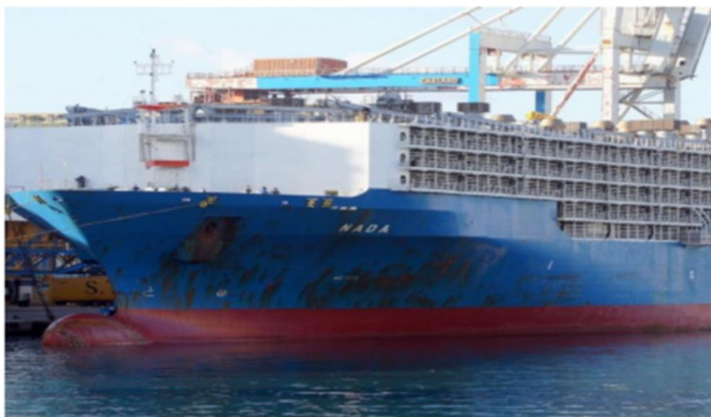
**Embarcação para transporte marítimo de carga viva. Nome da embarcação: 9005429; Bandeira: Panamá). Ano de construção: 1993. Comprimento: 140 metros; Largura: 32 metros; Calado: 10 metros. Capacidade (de animais): 30 mil (bois)**
